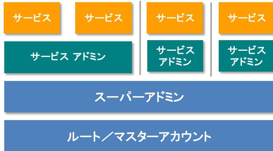
■ 基本的なクラウド管理プレーンにおけるユーザーアカウントの例。スーパーアドミン、サービスアドミンを含む。
